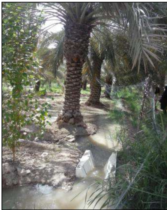
شکل ۲۳- نصب فلوم برای اندازه‌گیری آب آبیاری در نخلستان
